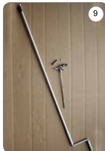
Korba, przegub Cardana 45° lub 90° z zaczepem dzwonkowym [9].
